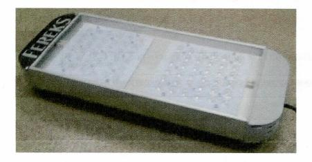
Проверка на прочность при воздействии механических ударов многократного действия (вид испытания)
